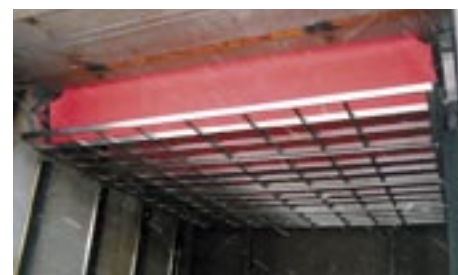
Norra Skogsägarna, Kåge Såg. Saxtryckramar inbyggda i en befintlig kammare.
