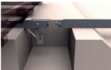
Yttre matarstång på väg mot inre stång
