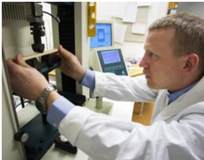
Pär Wiberg är en av två teknologie doktorer på Valutec. Här förbereder han ett bøjprov vid Luleå tekniska universitet, Skellefteå Campus.
